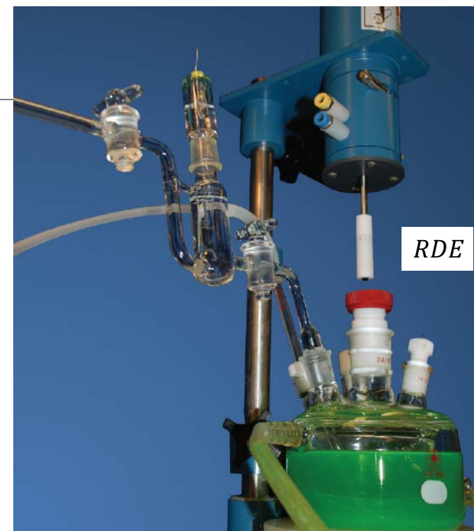
図 6.5 電気化学セルと電極。(a) 典型的な 3 電極セル, (b) 電極間の電位分布。基準電極と作用電極との間の電位差から作用電極の電位 E を求める。
